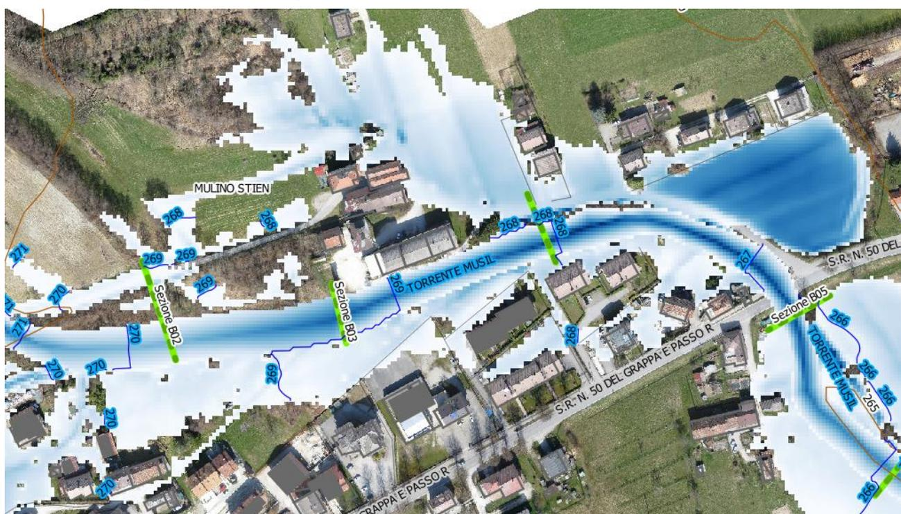
Figura 46 – Aree allagabili alla Fusinetta a monte dell'attraversamento della SR 50
