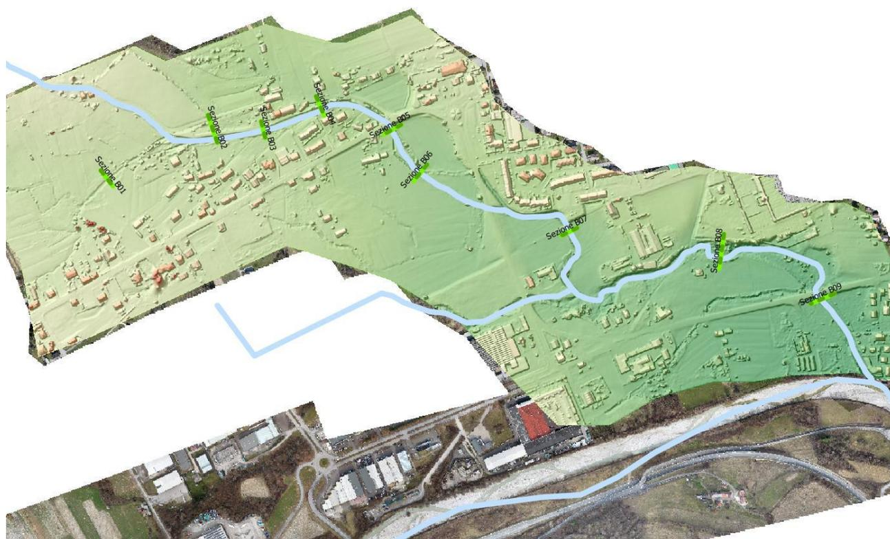
Figura 25 – Stralcio del dtm ottenuto e traccia di alcune sezioni rilevate con metodo tradizionale
