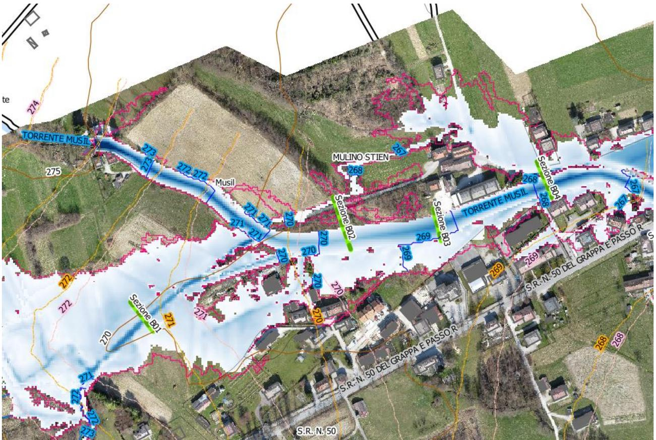
Figura 68 – confronto tra le aree allagate allo stato di fatto (limite in magenta) e quelle allo stato di progetto (su scala cromatica) in occasione dell'evento con TR=30 anni
