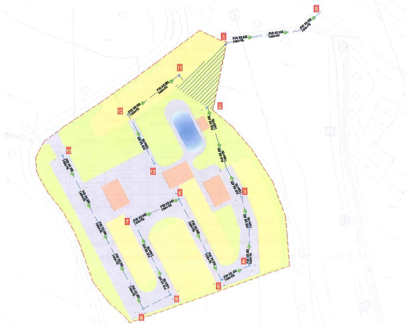
Figura 15 – Rete di captazione e smaltimento delle acque meteoriche in progetto
