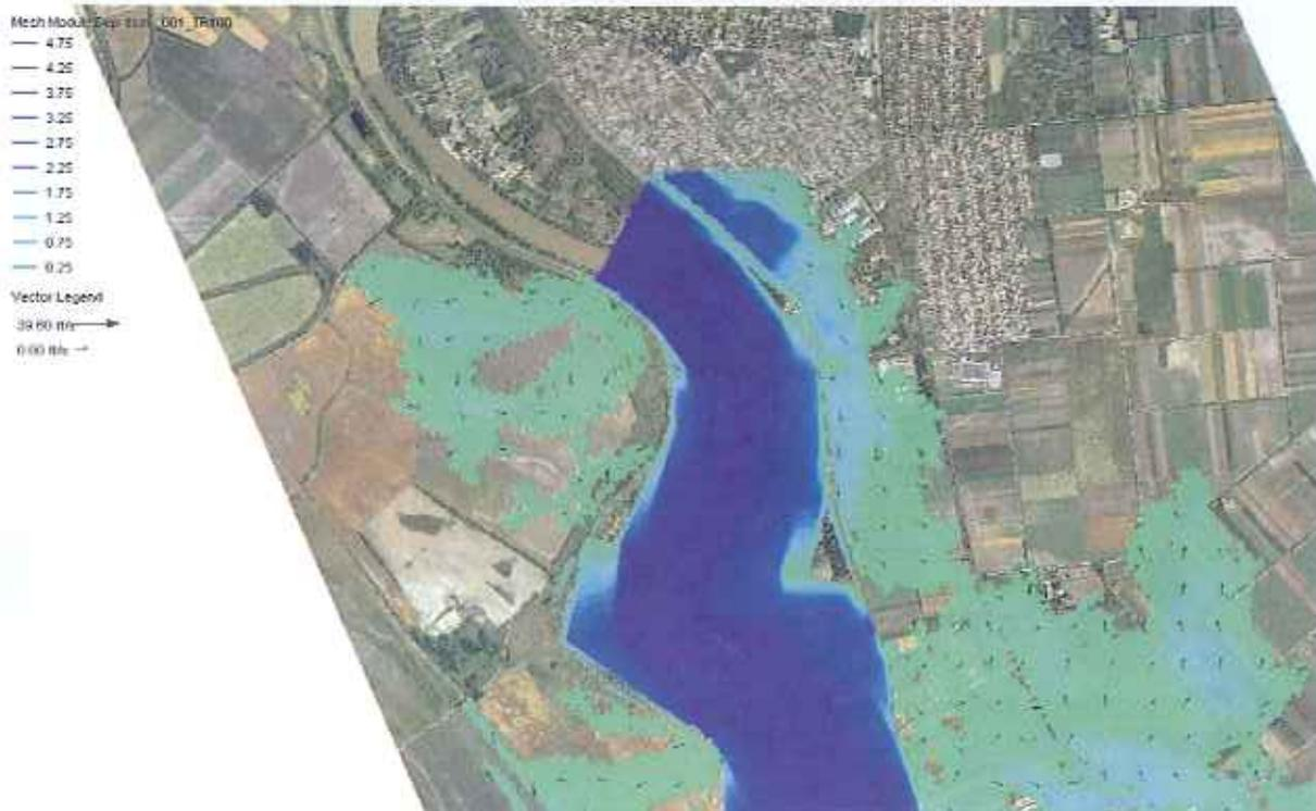
Figura 7 Esempio di visualizzazione dei risultati di simulazione idraulica mono-bidimensionale<sup>1</sup>
