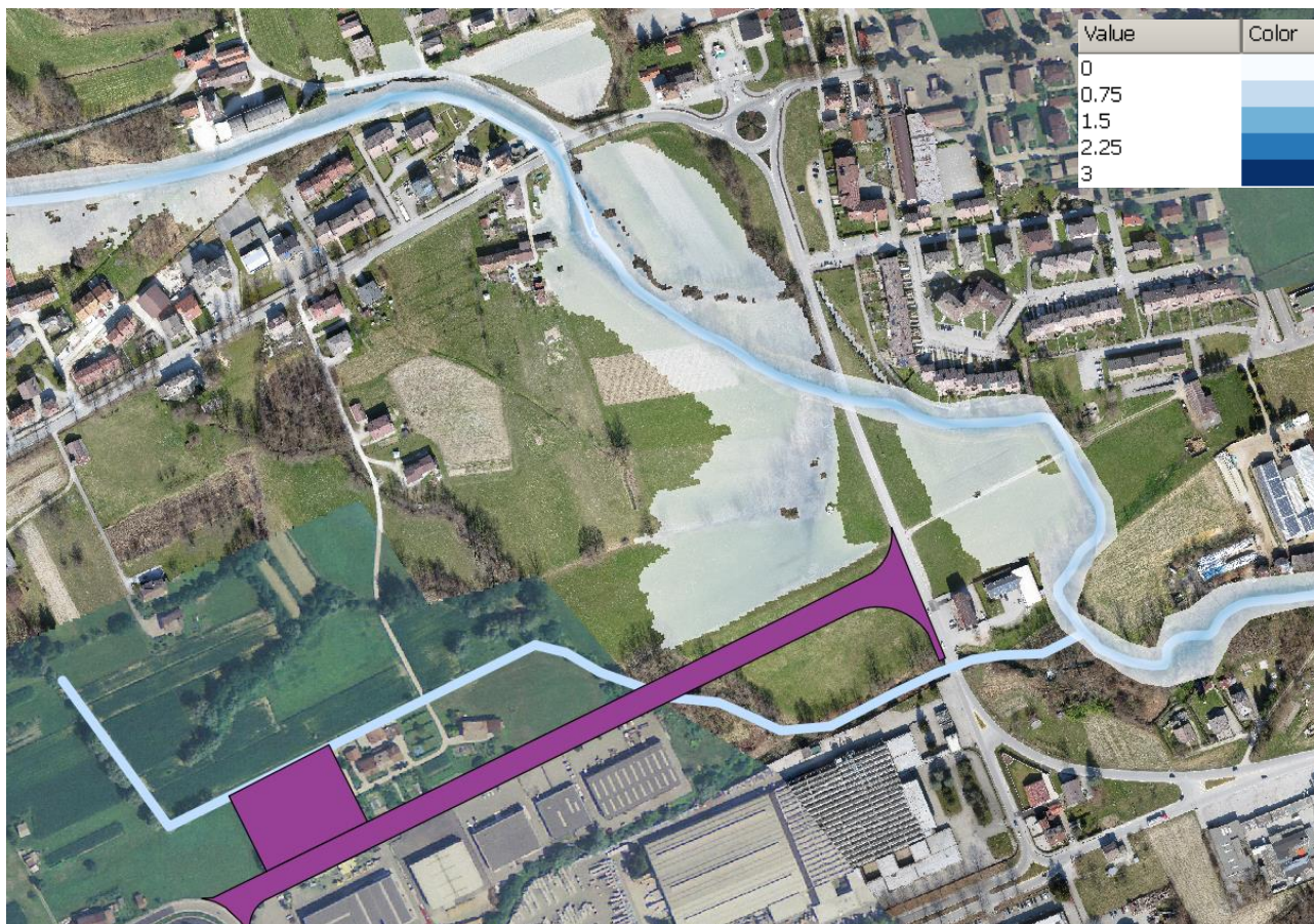
Figura 16 – Risultati della simulazione condotta nell'ambito dell'Indagine idrogeologica a Mugnai, nell'area ricompresa tra il Torrente Stizzon ed il torrente Musil finalizzata all'individuazione della causa degli allagamenti nell'area con individuazione delle possibili soluzioni tecniche" (Comune di Feltre 2014 – in corso) – inviluppo dei massimi livelli idrometrici registrati.
