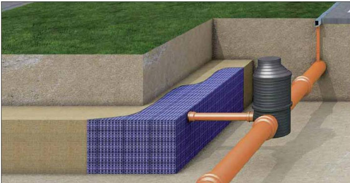
Figura 3 – Vasche interrate di laminazione
