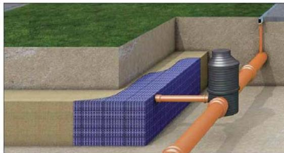
**3. Sovradimensionamento delle condotte di scarico e dei pozzetti delle acque bianche**
