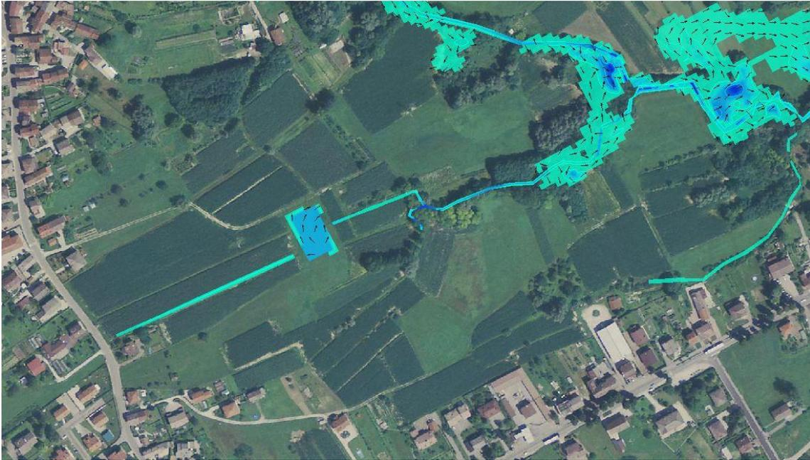
Figura 37 – evento di precipitazione di durata 3 ore e TR=50 anni simulazione riempimento della cassa dopo 2 ore
