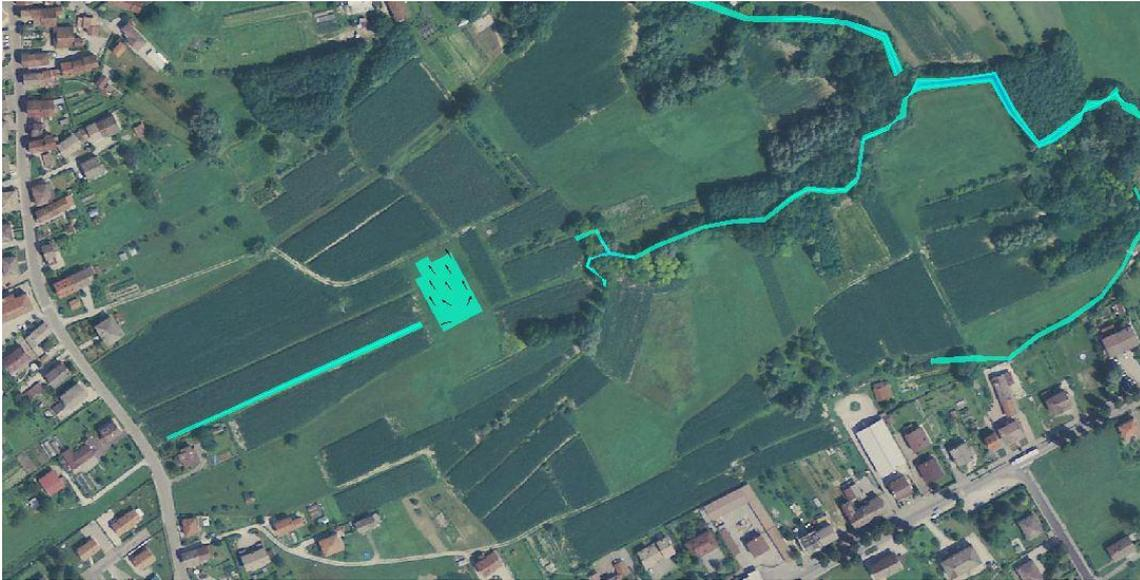
Figura 35 – evento di precipitazione di durata 3 ore e TR=50 anni - simulazione riempimento della cassa dopo 30 minuti
