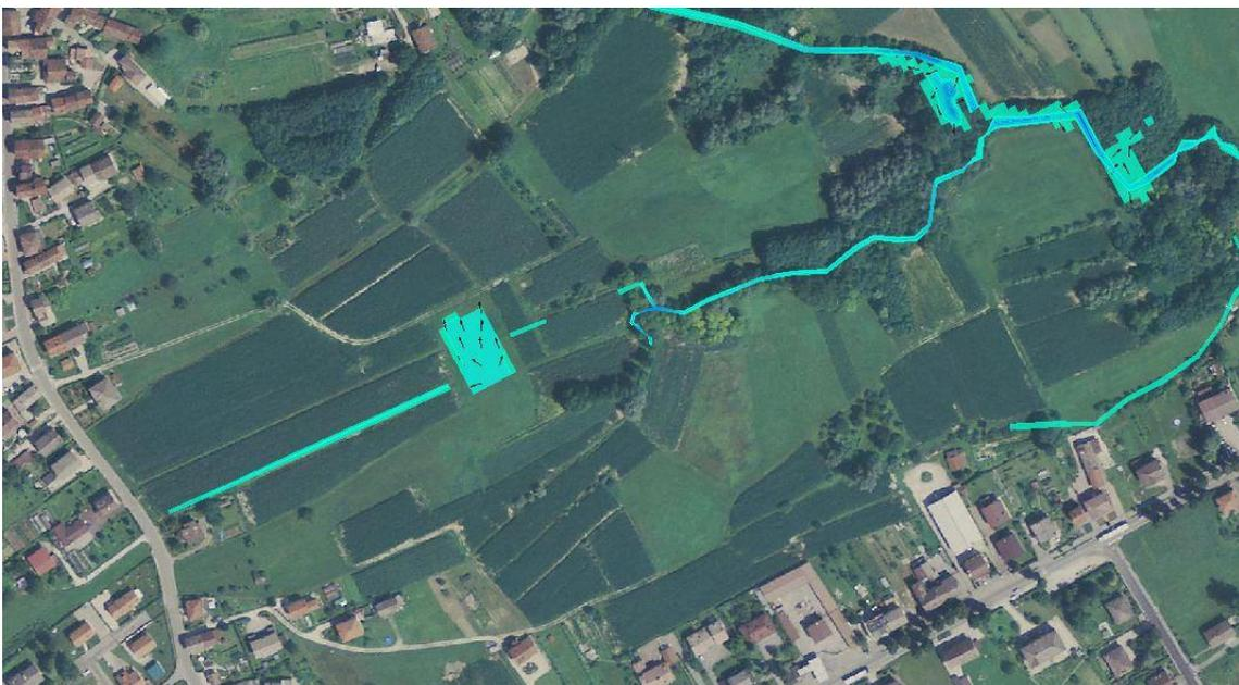
Figura 36 – evento di precipitazione di durata 3 ore e TR=50 anni simulazione riempimento della cassa dopo 1 ora
