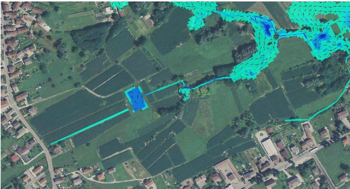
Figura 38 – evento di precipitazione di durata 3 ore e TR=50 anni simulazione riempimento della cassa dopo 3 ore
