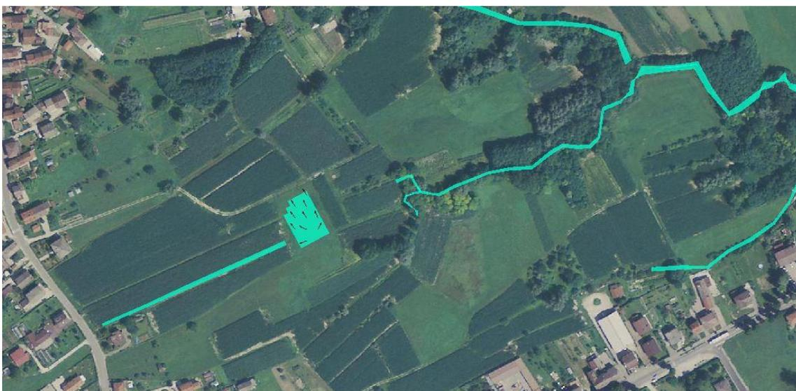
Figura 34 – evento di precipitazione di durata 3 ore e TR=50 anni - simulazione riempimento della cassa dopo 15 minuti
