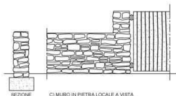
C) MURO IN PIETRA LOCALE A VISTA A CORSI IRREGOLARI E FILE PARALLELE
