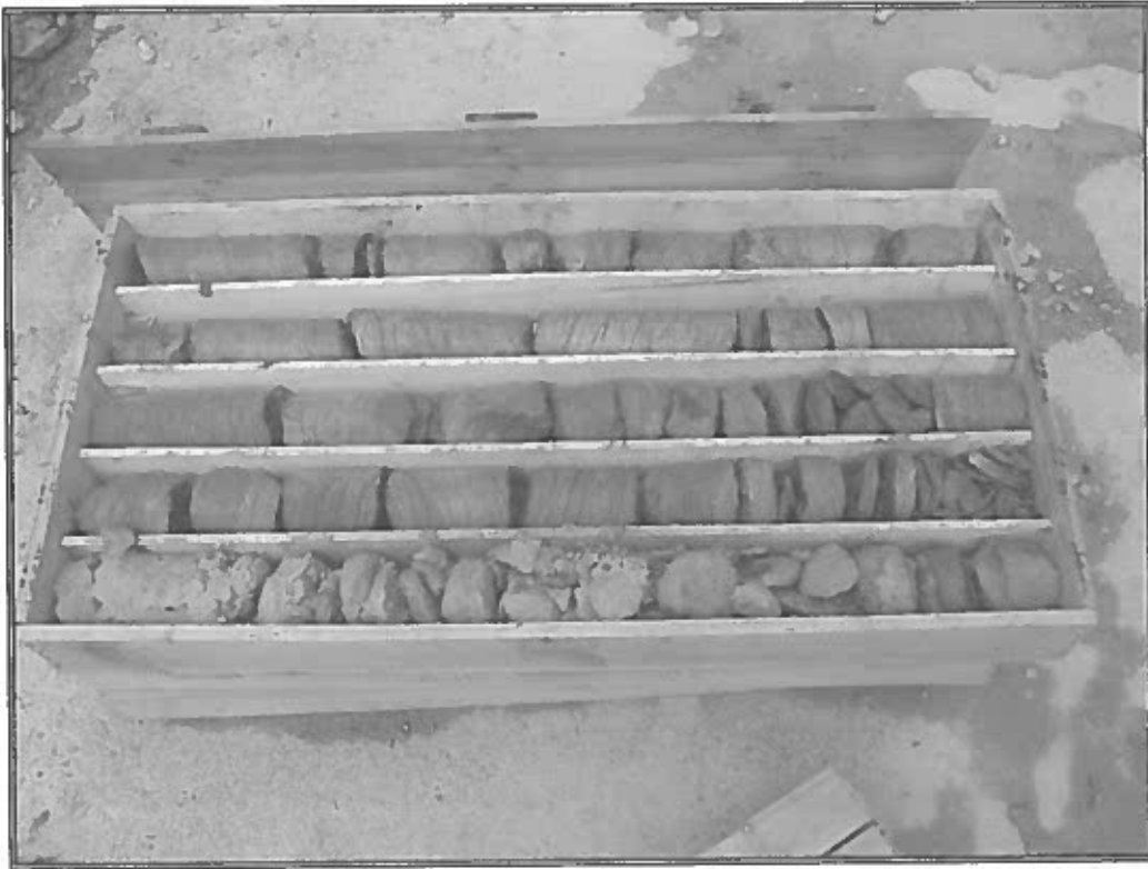
Foto 18. Sondaggio S4. da 10.00 a 15.00 metri di profondità
