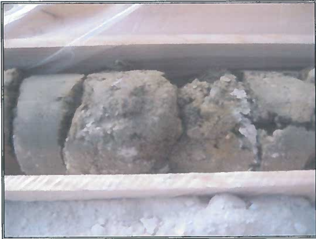
Foto 19. Particolare della foto precedente riportante i 20 centimetri, tra quota 3.30 e 3.50 metri di profondità, di materiale inquinato
