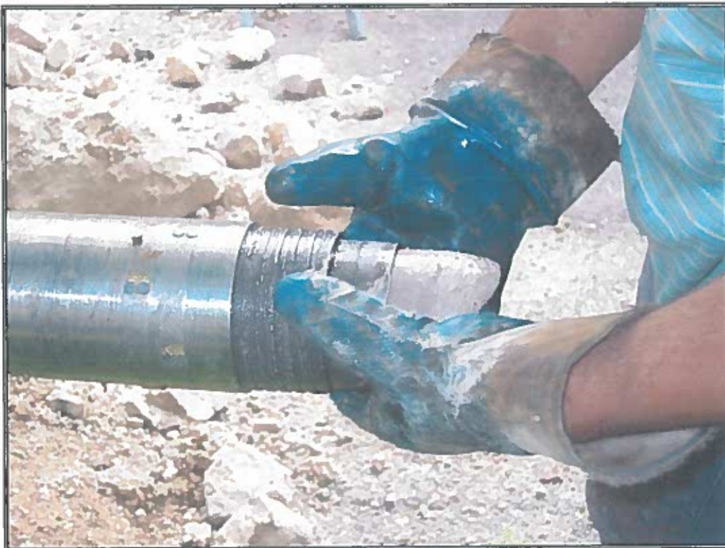
Foto 13 e 14. Fasi di estrazione del campione di roccia dal doppio carotiere
