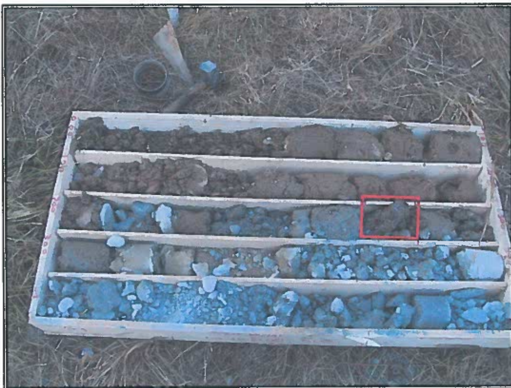
Foto 2. Sondaggio S1. Da 0.00a 5.00 metri di profondità. Riquadrato è evidenziato lo strato di terreno inquinato
