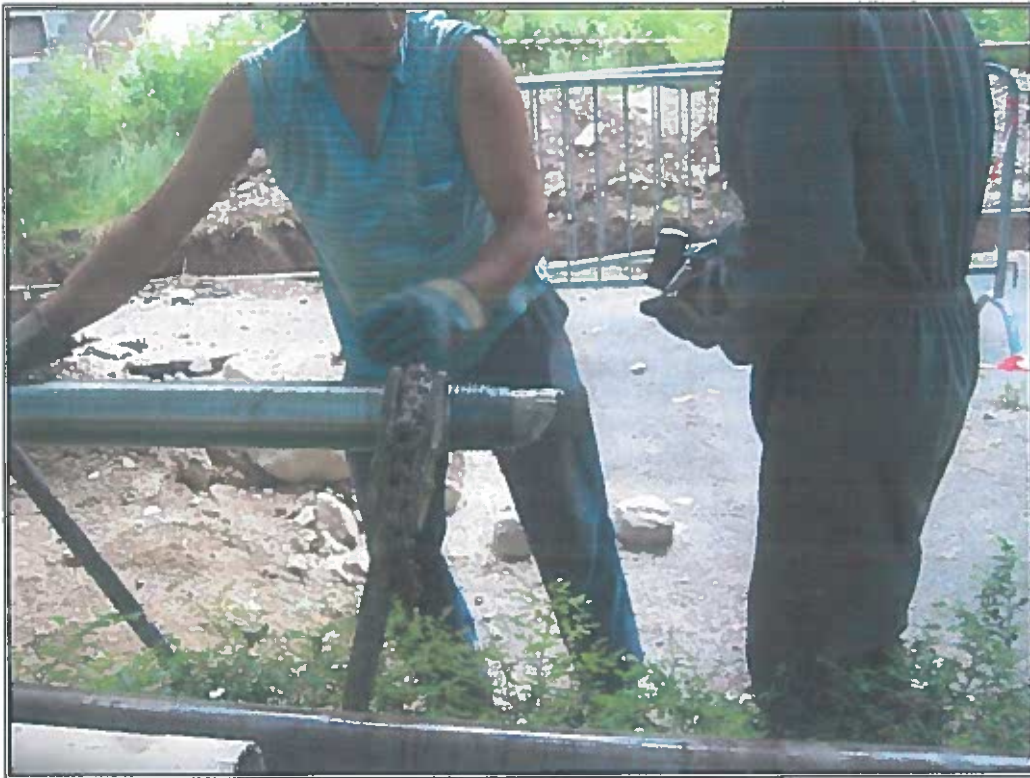
Foto 13 e 14. Fasi di estrazione del campione di roccia dal doppio carotiere
