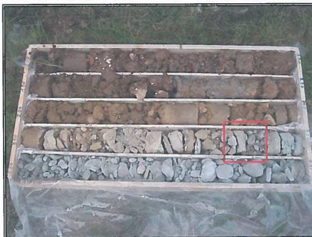
Foto 16. Sondaggio S7. Da 0.00 a 5.00 metri di profondità; riquadrato è evidenziato il livello materiale, tra - 3.80 e - 3.90 metri di profondità, prelevato per le analisi di laboratorio
