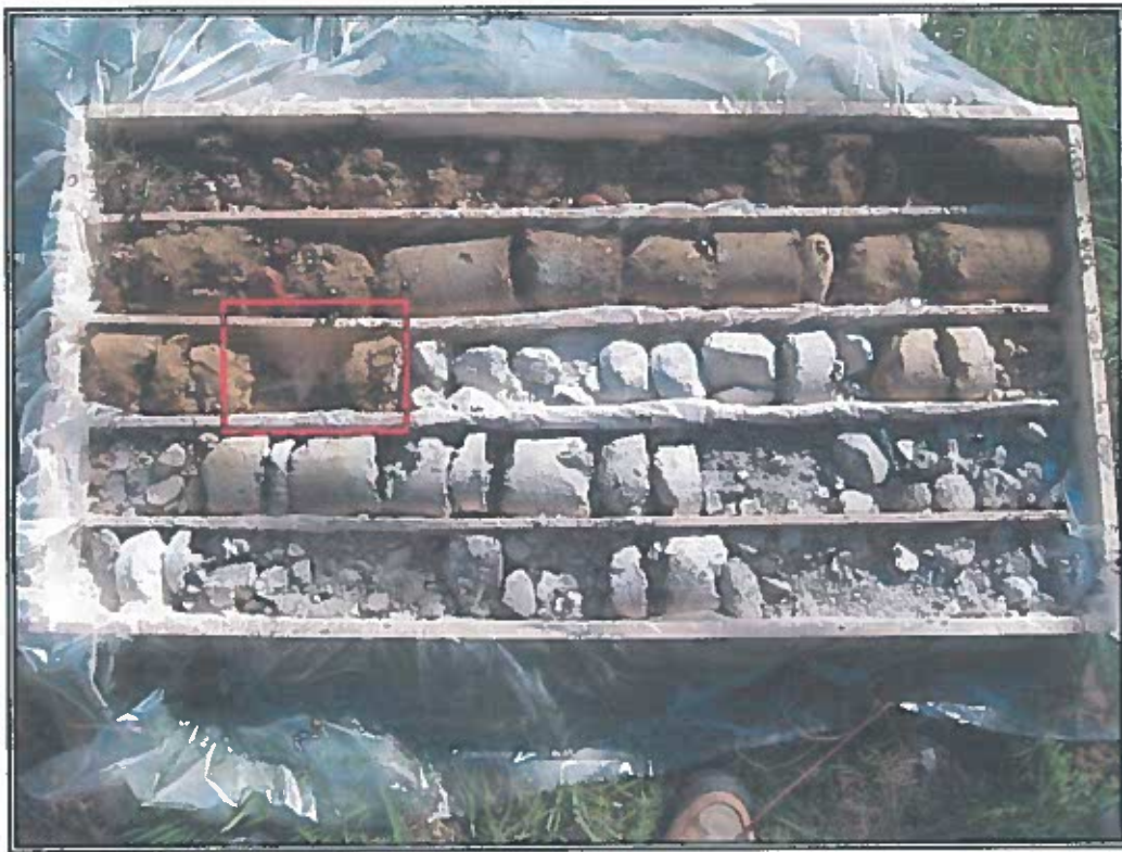
Foto 21. Sondaggio S9. Da 0.00 a 5.00 metri di profondità; riquadrato è evidenziato il livello materiale, tra - 2.20 e - 2.30 metri di profondità, prelevato per le analisi di laboratorio
