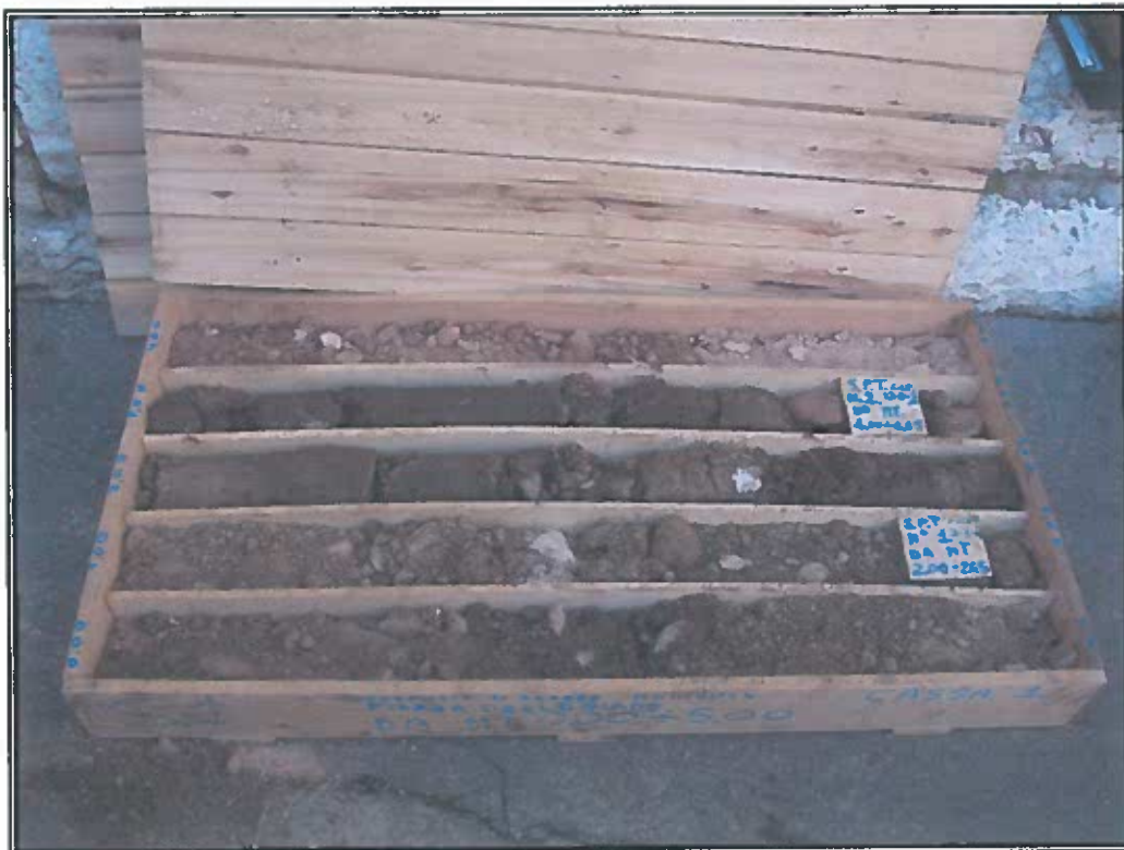
Foto 2. Sondaggio S1. Da 0.00 a 5.00 metri di profondità
