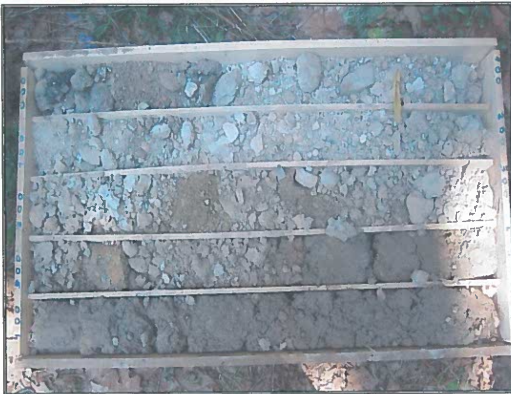
Foto 10. Sondaggio S3. Da 0.00 a 5.00 metri di profondità
